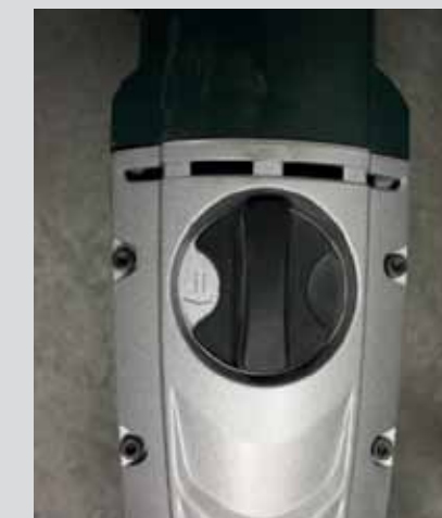
Metabo har en stort lättmanövrerat vred som sitter bra till ovanpå maskinen.
