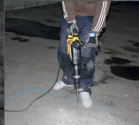
Maskinen är relativt kort, men eftersom du kan placera södhandtaget högt upp på maskinen är det lätt att hitta ett skönt grepp.
